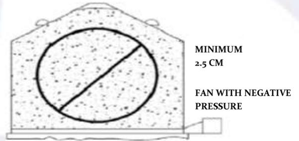
THE ROOF WILL BE DAMAGED IF HEAT CONTROL CABLES ARE ATTACHED TO THE GROUND AS IN THE PICTURE BEFORE SILO FILLING
